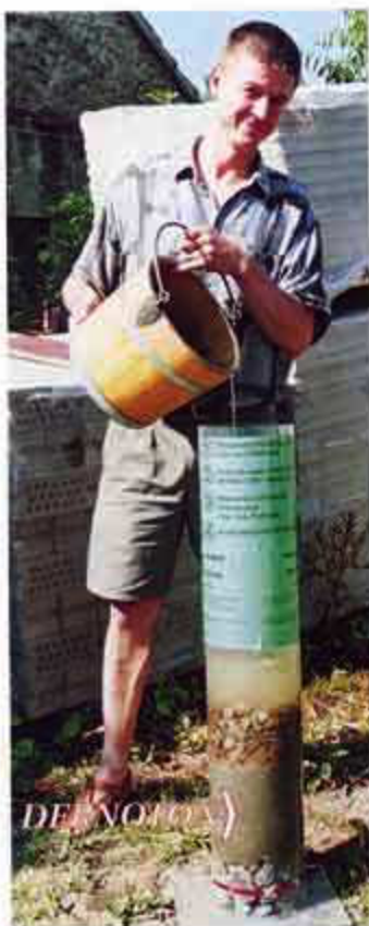
Praxislaurentest: Am Behälterboden befinden sich Löcher. Würde das Dichtungsmaterial unwirksam, könnte man im Laufe der Zeit Wasserzutritt beobachten.
