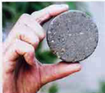
Dernoton in verdichteter Form. Es hält die Feuchtigkeit von Hausmauern im Erdreich fern.
