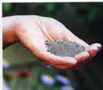
So sieht mineralisch angereicherter Ton in Pulverform aus. Durch Verdichtung und Nassseinswirkung hat Feuchtigkeit keine Chance mehr.
